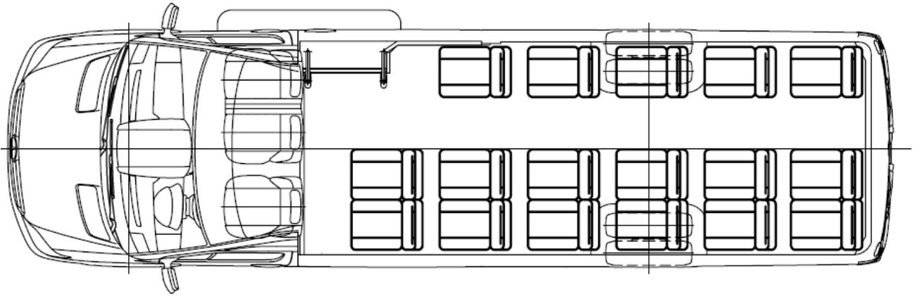
Вход пассажиров в автобус осуществляется через переднюю распашную дверь, напротив водителя и правую сдвижную дверь пассажирского салона.
